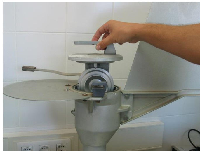
Figura 10: Introducción del cabezal en el interior de la carcasa de la unidad de impacto.
