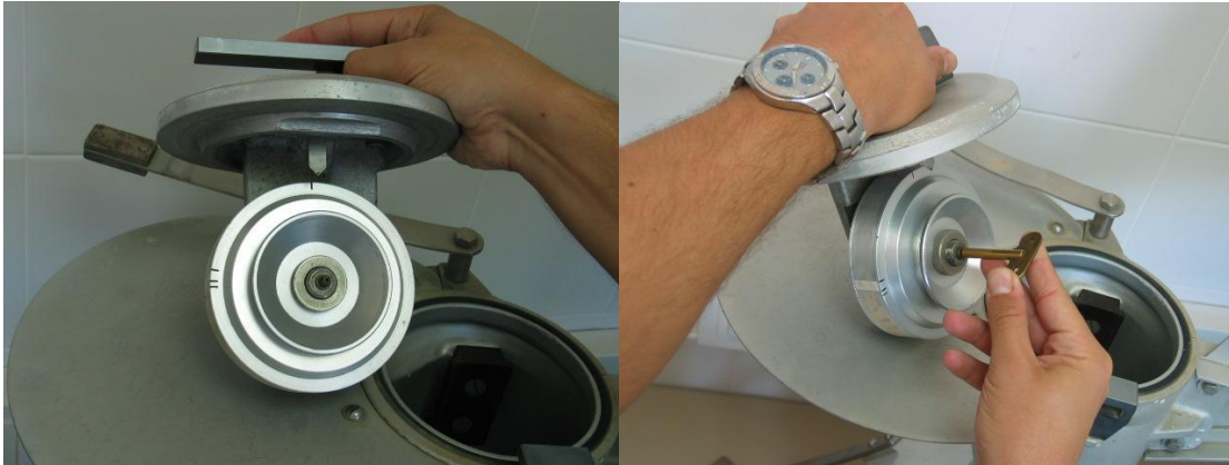
Figura 8 (izqda.): Colocación del tambor en posición correcta. Figura 9 (dcha.): Dando cuerda al reloj de la unidad de impacto.
