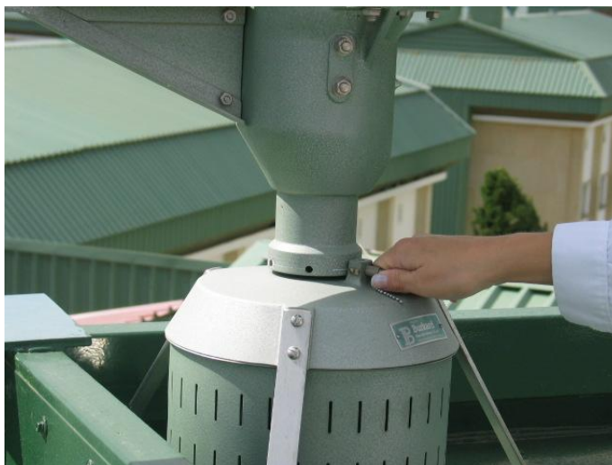
Figura 6: Fijación de la veleta en el modelo Burkard 7-day recorder spore trap.
