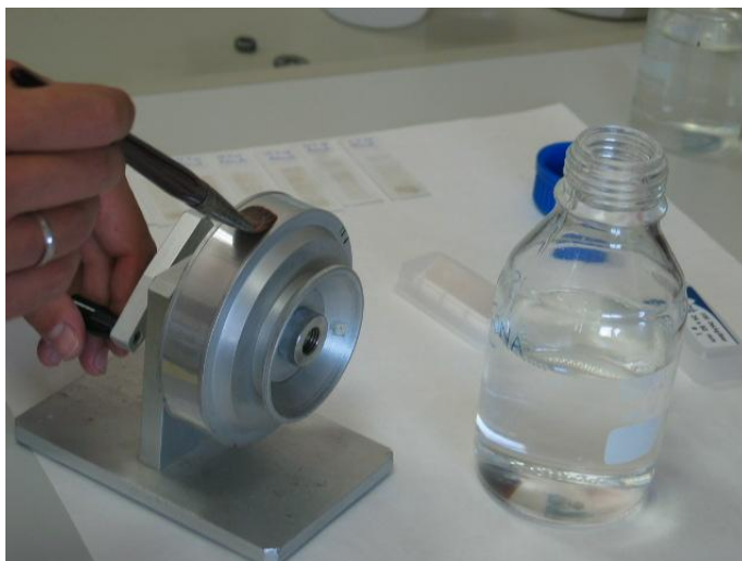
Figura 5: Aplicación de fluido de silicona sobre la cinta de Melinex dispuesta sobre el tambor.
