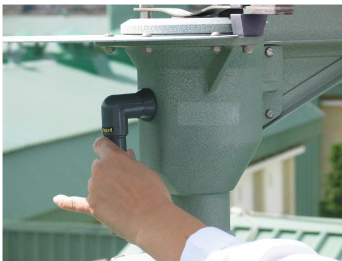
Figura 7: Comprobación de volumen de succión en el modelo 7-day recorder Burkard spore-trap.
