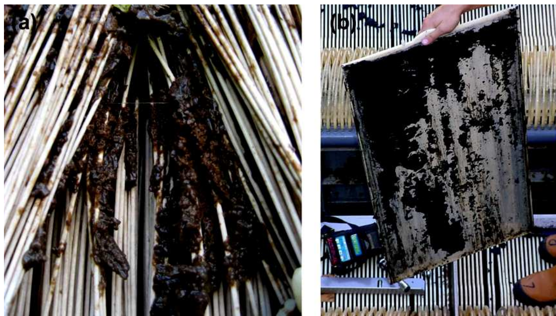
Figura 16.- Ensuciamiento de unas membranas de fibra hueca y plana respectivamente.
