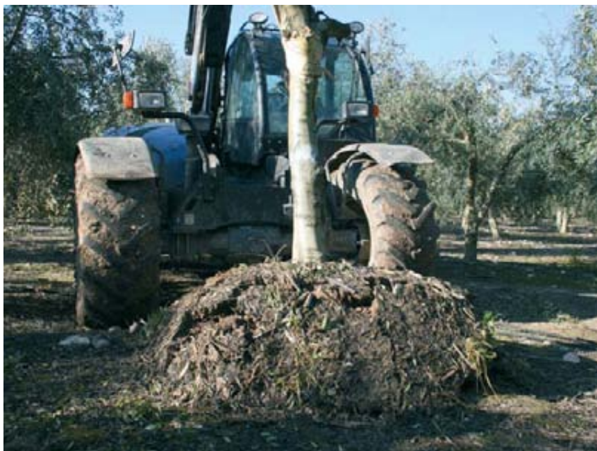
Arranque de olivo con manipuladora telescópica para determinar el peso de las raíces, tronco y ramas principales.
