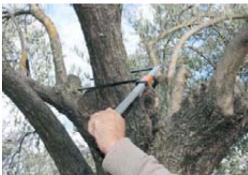
De arriba a abajo. Toma de muestra en tronco de olivar con la sonda Pressler para determinar la densidad de la madera.
