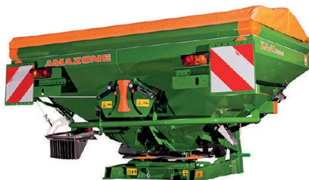
**Figura 16.** Distribuidor centrfugo de fertilizantes slidos (Fonte: Amazone)
