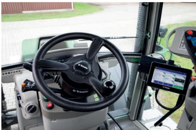
**Figura 9.** Sistema móvel diretamente ligado ao volante (Fonte: Trimble)
