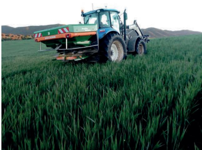
**Figura 22.** Distribuição de fertilizantes por distribuidor de adubo centrífugo (Fonte: Projeto Innovatrigo)
