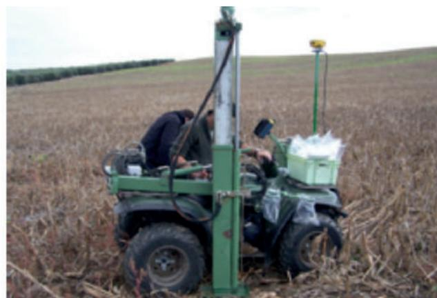
**Figura 13.** Quadriciclo preparado para amostragem do solo (Fonte: projeto Innovatrigo)
